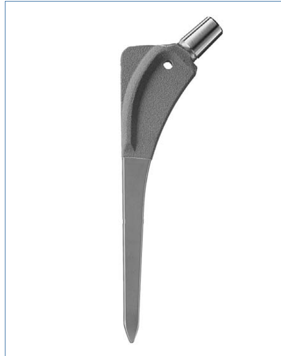
Abb. 1 Der BiCONTACT-Schaft zur zementfreien Implantation. Zu beachten sind die proximale Beschichtung, der laterale Antirotationsflügel und die anterioren (und posterioren) Abstützrippen
